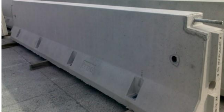
Figura.- La nueva barrera de seguridad New Jersey, construida con plásticos y material reciclado a partir de neumáticos fuera de uso, supone una mejora respecto a los sistemas de protección convencionales porque absorbe mayor energía del impacto y reduce las emisiones de CO2 generadas durante el proceso de fabricación
