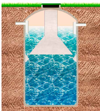
Figura 7: Ejemplo de tanque Imhoff
