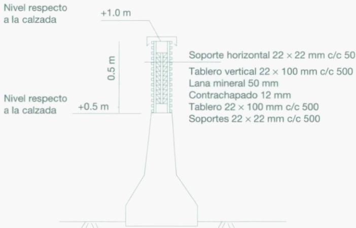
*Pantalla en madera de 0,5 m., montantes en acero, de cada lado, listones horizontales en madera sobre planchas verticales, lana mineral para la absorción acústica y en medio contraplaqué erigido sobre elementos de barrera de seguridad en hormigón de 0,5 m. de altura (tipo 7b, cuadro 6.3)*
