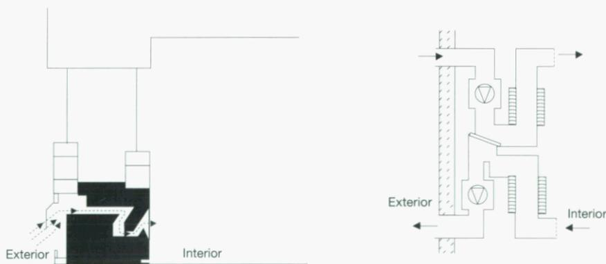
**Figura 4.11. Aislamiento de fachada de una vivienda existente con una galería acristalada.**
