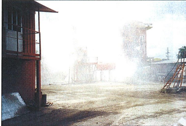
FOTOGRAFÍA 3.3 FUGA ACCIDENTAL DE POLVO EN LA PLANTA
